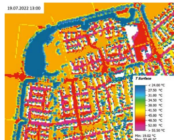
Berechnung der Bodentemperatur in Bodenhöhe – (Worst-Case-Szenario)
