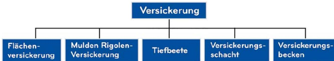
Abb. 2: Möglichkeiten der Niederschlagswasserversickerung
