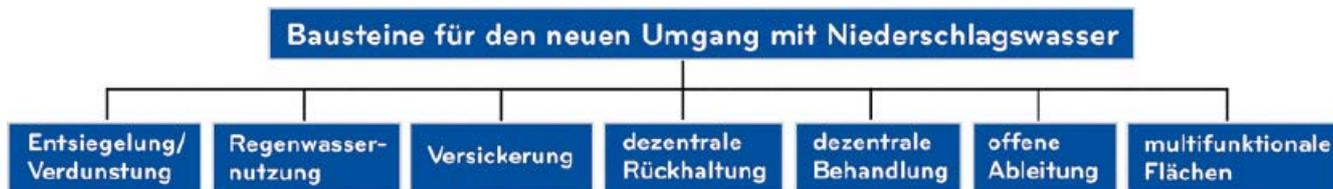
Abb. 1: Bausteine für den Umgang mit Niederschlagswasser
